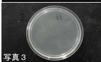
写真3 消石灰混合3日後の細菌数
