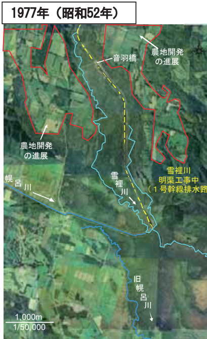
• 雪裡川は1973年～1979年の直轄明渠排水事業により直線河道となった。 • 音羽橋周辺では農地開発が進展した。 • 幌呂川が切替えられ雪裡川に接続した。
