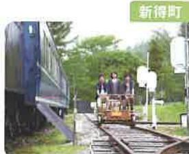
狩勝高原エコトロッコは、旧狩勝線の新駅構内でレール走行ができる保線用軌道自転車。全長800mのコースが整備されている。
