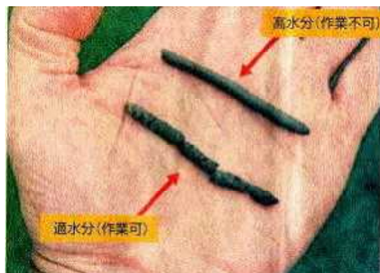
サブソイラ作業時の土壌水分の判断方法
