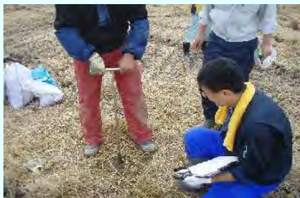
検土杖による土壌調査（農地の機能評価）
