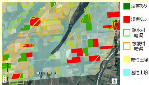
湿害と暗渠の整備水準を表示した例
