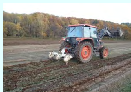
サブソイラーによる心土破碎（暗きょ排水機能の持続対策）
