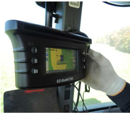
写真一 GPSガイドランス ニコントリブル EZ-Guide250
