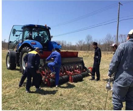
写真1 作溝播種機の調整作業
