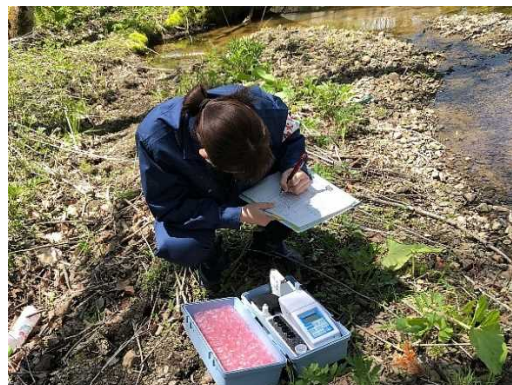
河川水濁度調査
