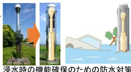
浸水時の機能確保のための防水対策
