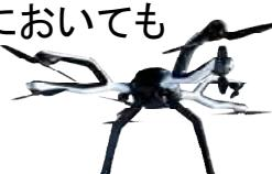
風速20m/s程度の強風下で飛行可能
