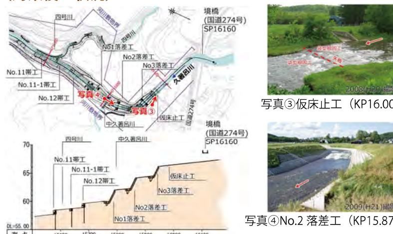
● 河床低下の進行を防止するため、平成19年に緊急的に仮設帶工を施工しました(写真③)。
