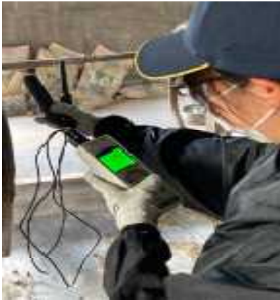
写真1 環境測定器と風速計で牛舎環境を測定
