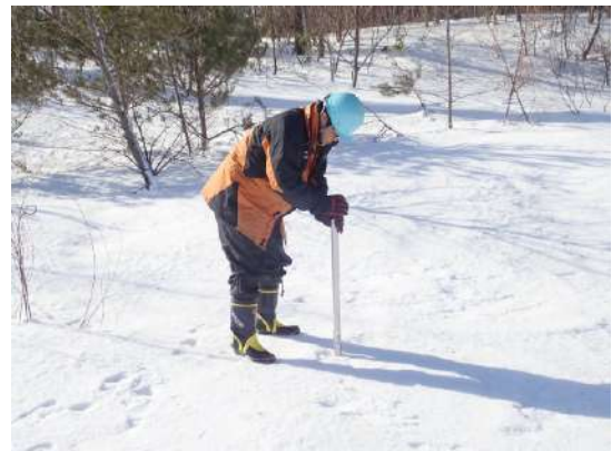
図 3.3 スノーサンプラーによる積雪採取
