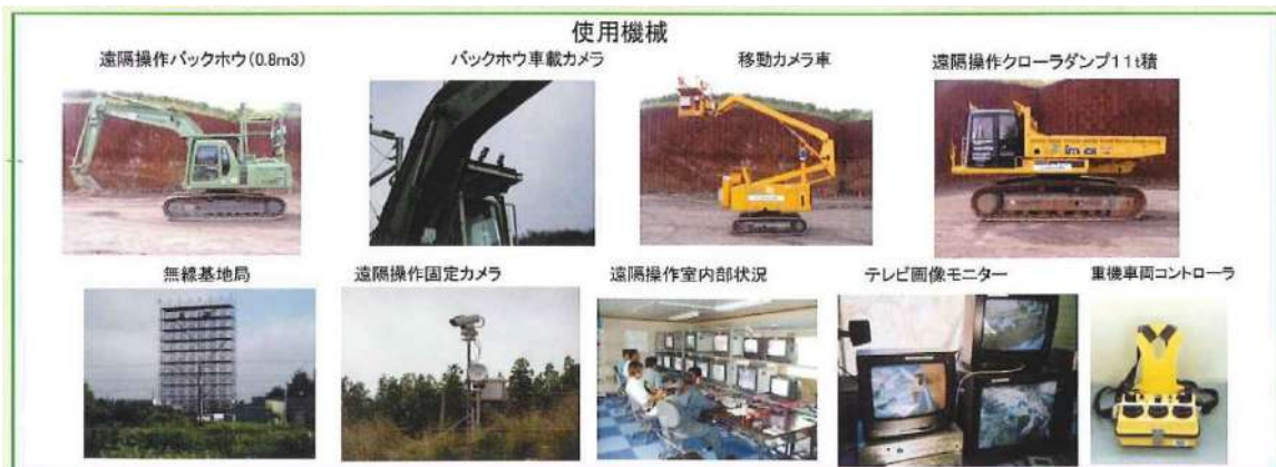
図 5.4 無人化施工で使用する主な機材
