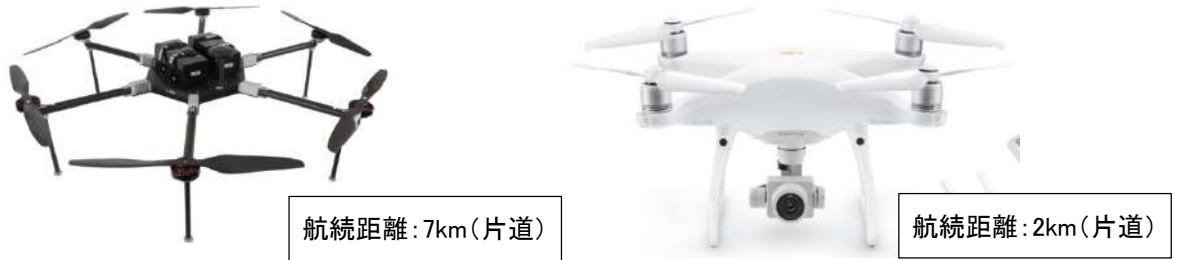
図 4.8 UAV の外観（左：サーベイ機、右：ホビー機）
